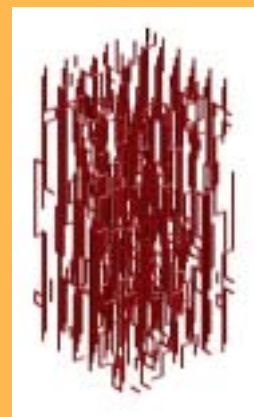
Simulering av vortexlinjer i en modell av en högtemperatur-supraledare.
