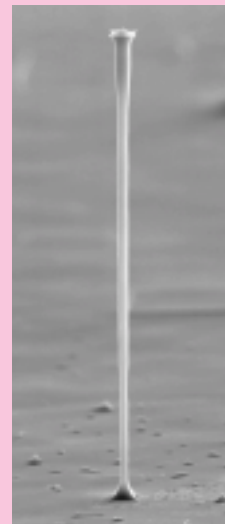
120 \mu\text{m} hög pelare etsad i kisel med elektrokemisk etsteknik
